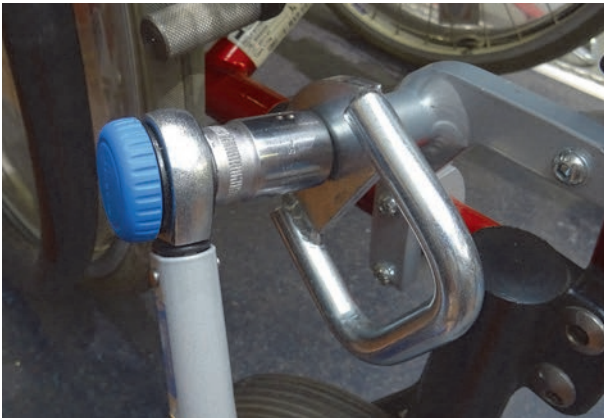
Abbildung / Figure 13: Verschraubungen festziehen / Tightening the bolts
