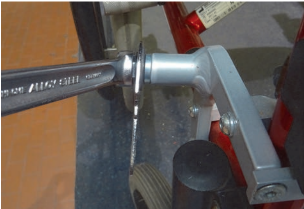
Abbildung / Figure 5: Schlosszunge vorne demontieren / Removing the front buckle latch
