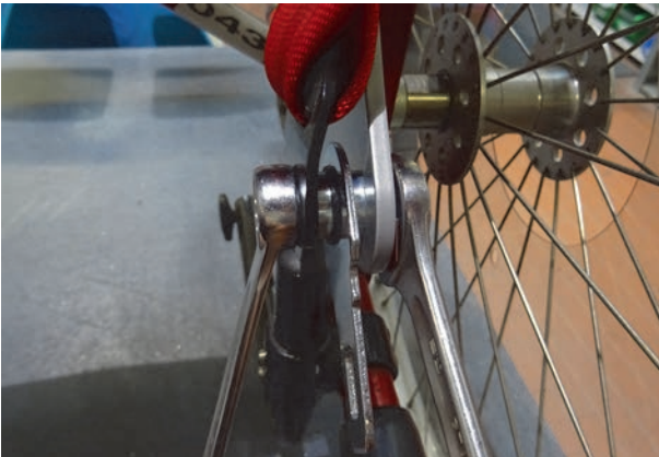
Abbildung / Figure 8: Schlosszunge hinten demontieren / Removing the rear buckle latch
