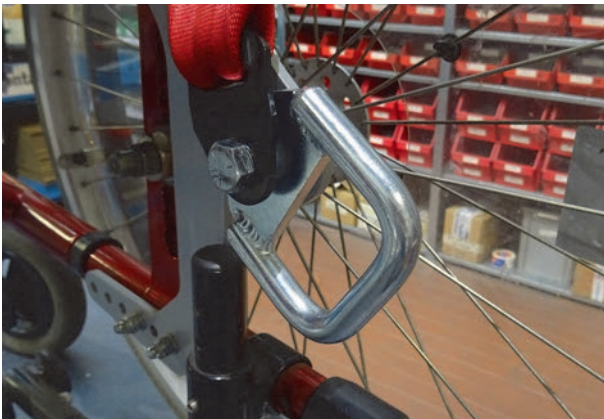
Abbildung / Figure 12: Schwerlastöse hinten montieren / Fitting the rear heavy duty eyelet (4)
