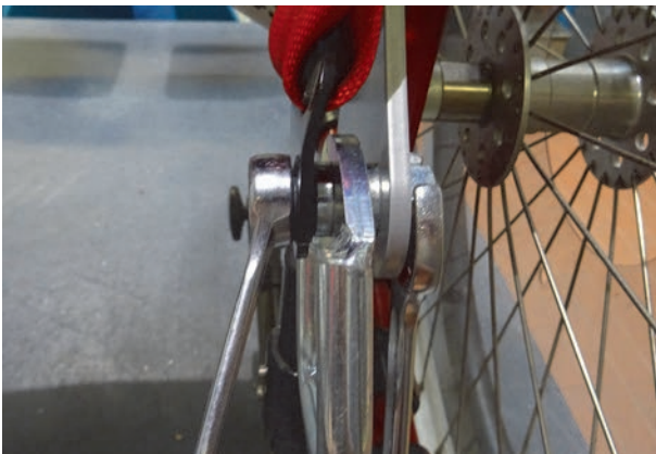
Abbildung / Figure 11: Schwerlastöse hinten montieren / Fitting the rear heavy duty eyelet (3)
